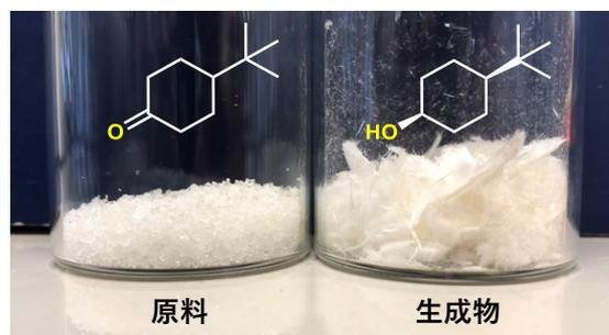
図4. 本反応に用いた原料と実際に合成した環状アルコール(シス体選択性98%)
