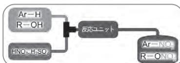
多くの懸念があるニトロ化反応をフロー合成で制御することを可能に。リスクを軽減した効率の良い製法へ改善しました。スケールアップにも有効です。
