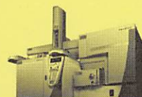
TSQ Quantum XLS Ultra GC-MS/MS 世界初 0.1Da による ultra-SRM に成功 高選択性の GC トリプル四重極
